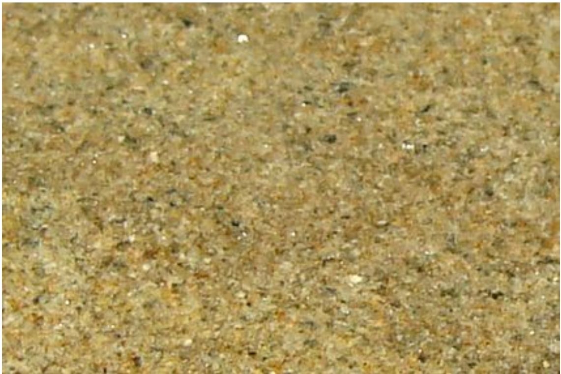
Foto č.1 .: Vzorka č.2 Svetlohnedý jemnozrnný pieskovec . Portál (veľký) z nádvorja, Oravský hrad. Hornina je vytvorená z rovnomerne zrnitej masy zŕn minerálov. V hornine nevidieť pórovitosť. Hornina pôsobí kompaktné s malým množstvom trblietajúcej sa svetlej sludy – muskovitu. Obyčajné svetlo, zväčšenie 10 x.
